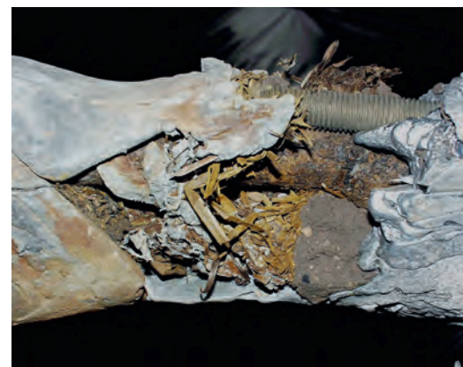
5 Detail der Innenkonstruktion: Korrodiertes Armierungseisen, spätere Verfüllungen mit Mörtel, Gips, Holzwolle, Messingstangen und Bleiverguss.
