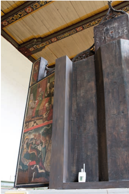
4 Funksensor für Temperatur und relative Luftfeuchtigkeit an der Rückseite eines Flügelretabels.
