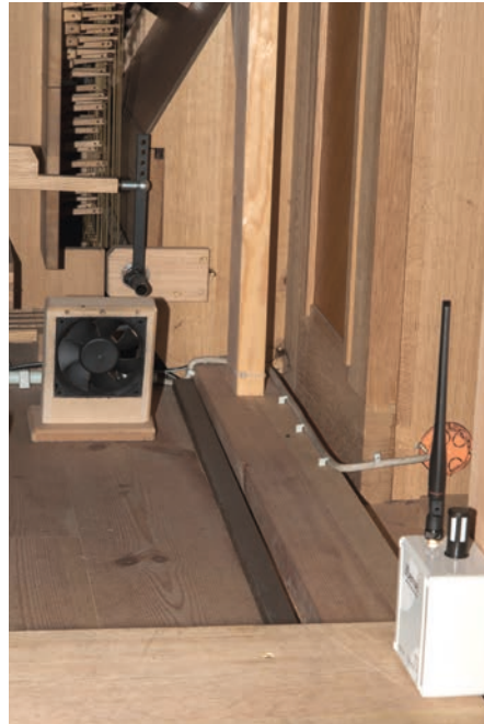
5 Mobilfunk-Datenlogger, im Hintergrund ein Computerlüfter zur Luftumwälzung in einer Orgel.
