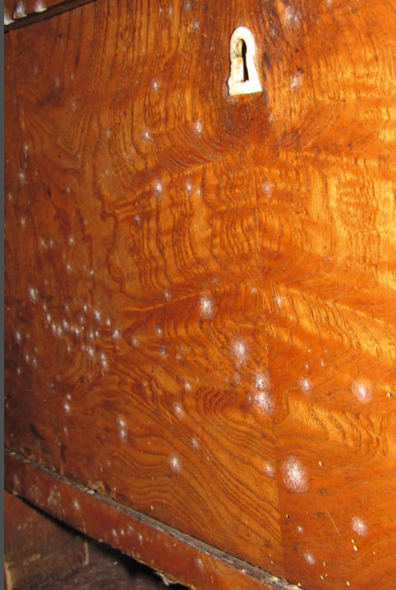
2 Ungünstiges Raumklima fördert das Wachstum von Schimmelpilzen, hier auf dem Furnier einer Biedermeier-Kommode.
